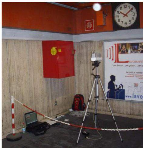
Fig. 6: Strumentazioni Grimm poste ad altezza di respirazione uomo
