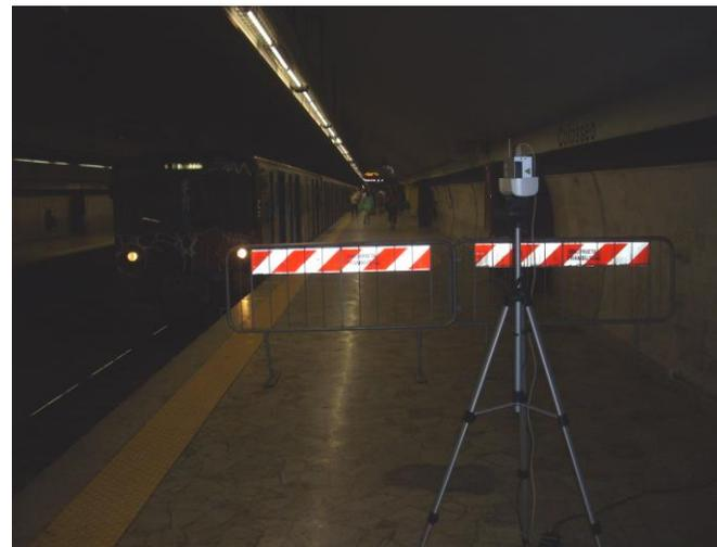
*Fig. 2 e 3: Strumentazioni Grimm poste ad altezza di respirazione uomo*
